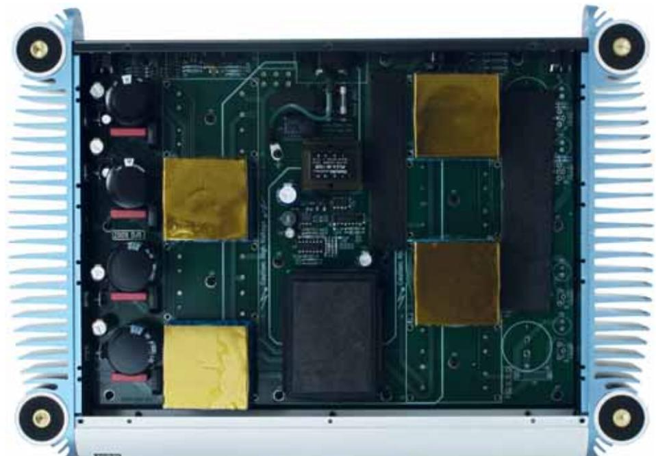
Il layout interno del Platinum DAC è estremamente ordinato: da notare i 4 moduli dorati ognuno contenente una unità di conversione A/D.
